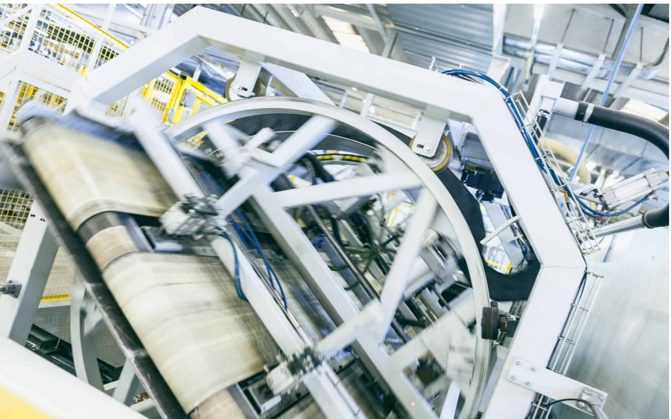
All'interno dello stabilimento, alcune fasi della lavorazione e della termoformatura, lamine termoplastiche nei caricatori multipli. Within the factory, some manufacturing and thermoforming processes, thermoplastic foils inside multiple loaders.
